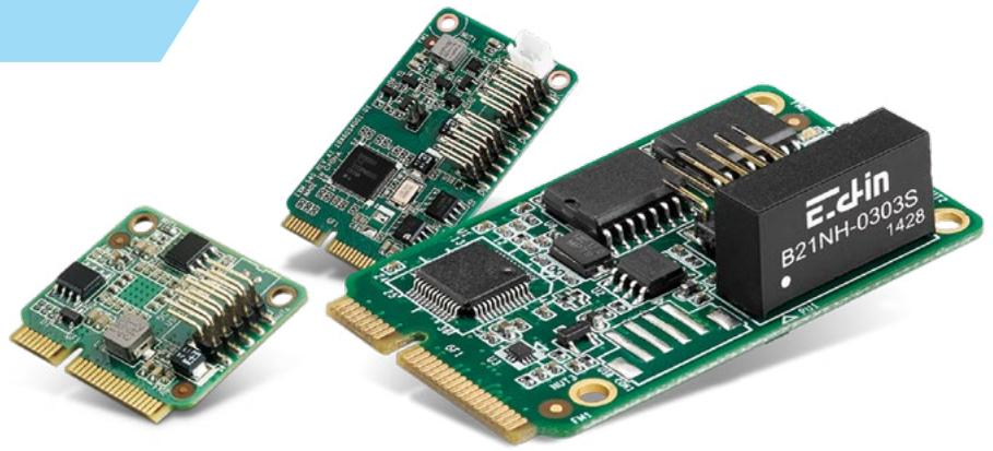
EXM 模块提供标准的全尺寸微型 PCIe 模块，为嵌入式板和系统提供各类 I/O。
