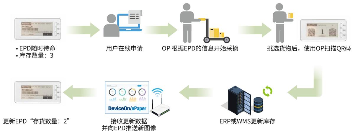
该EPD-230为2.9英寸无线电子纸设备,可授权仓库操作员轻松定位货物和根据工单验证组件。有了DeviceOn/ePaper,所有数据都可以在现有的RMA库存管理控制系统中实现自动更新,从而大大提高库存管理效率。
