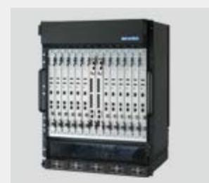
ATCA总线主要针对电信运营级应用, 但其易于扩展、易于加固的欧卡式刀片结构逐渐被军工行业认可, 随着战场信息化程度越来越高, 军方对信息处理的计算性能及存储性能要求也越来越高, 基于ATCA的加固服务器应运而生
