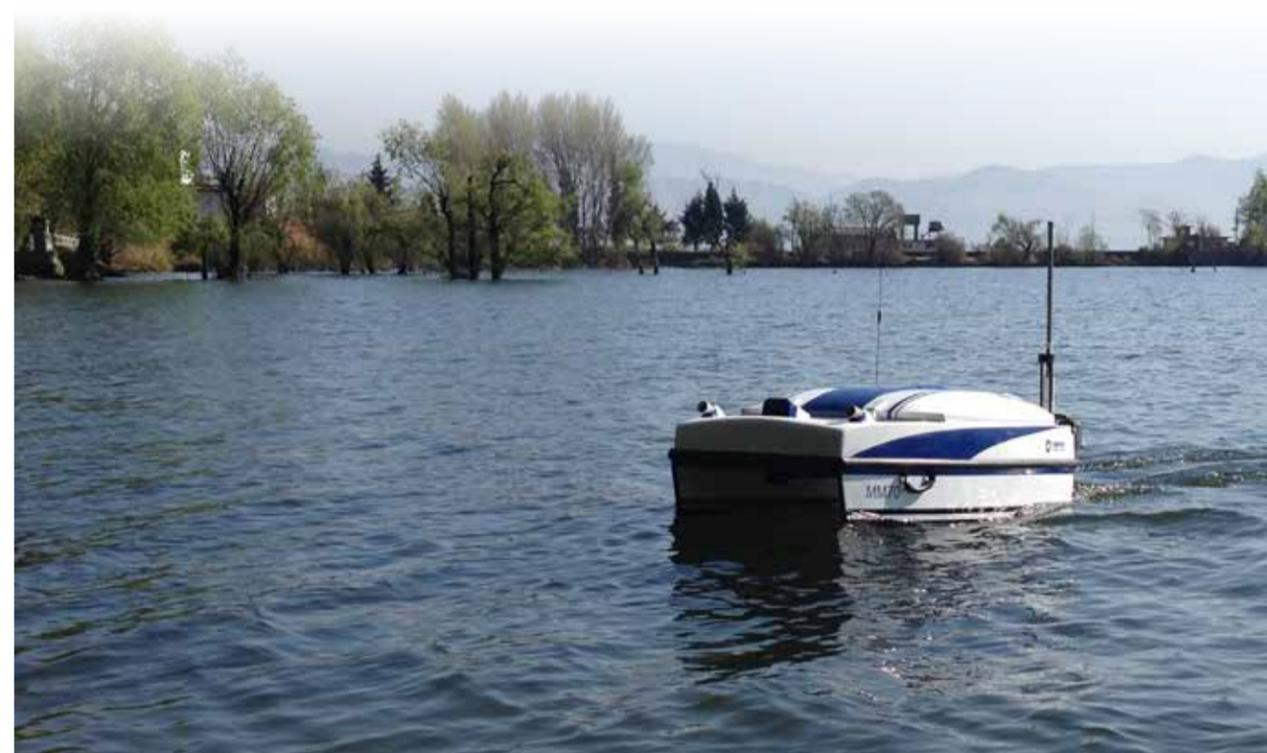
扫描到排污暗管时，不会产生回波，这让排污暗管原形毕露。无人船还能对排污暗管拍照并记录经纬度，让环保部门一抓一个准。另一条船上挂着监控棒，能沿着指定河段从下游到上游依次对水质进行采样和检测，并将数据绘制成污染分布图。它还能在水下暗管附近有针对性地取样，以提供执法依据。
