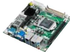
Intel® Core™ i7/i5/i3 LGA 1150 CPU 的MiniITX主板, VGA/DP/HDMI(DP)/LVDS(eDP), 2个COM, 双千兆网口, PCIe x 16扩展
