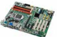
LGA1155第三代Intel® Core™ i7/i5/i3/奔腾 ATX 主板, 支持DVI/VGA, USB 3.0, PCIe Gen III
