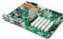
LGA775 Core™ 2 四核ATX 主板, 支持双VGA/DVI显示, 4 COM, 双LAN
