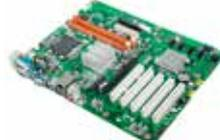
LGA775 Intel® Core™ 2 四核ATX 主板, 支持单VGA, 2 COM, 单LAN
