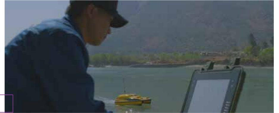
着指定河段从下游到上游依次对水质进行采样和检测，并将数据绘制成污染分布图。它还能在水下暗管附近有针对性地取样，以提供执法依据。
