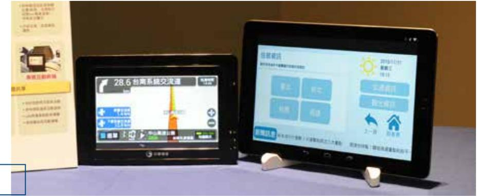
电子技术的进步与日渐升高的高竞争态势，未来出租车一定会导入信用卡与电子票证等金流服务与更多车辆安全服务，因此 4G 智慧车载终端设备强化了扩充周边的整合性，提供包括 RS-232、DI、Video in、USB 2.0 等 I/O 端口和 G-Sensor 感知功能，可与金流周边及车内其他传感器、行车计算机轻易整合，与目前市面上的专用车机相较，此 4G 智能车载终端设备的 4G 通讯模块与规格设计都是走在时代的前端。
