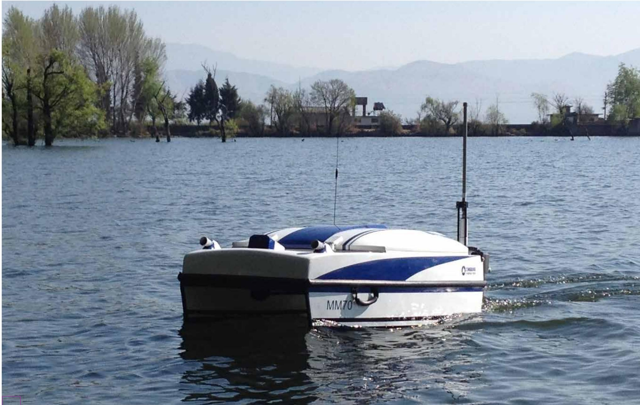
无人船一边通过声呐、激光和雷达等技术探测障碍物，一边实时计算出蔽障路线，并选择最佳巡航线路，在到达目的地之后通过传感器对水样进行自动抽样和检验。
