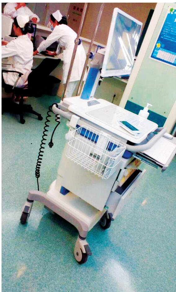
数字医疗事业处产品经理王智晖表示，AMiS-50 使用研华既有主机板进行改造，电脑本体为一体成形设计，体积小，散热快，没有风扇、连接线与缝隙，不容易累积灰尘，可以有效做好感染控制，且研华也提供智能管理平台，可同时监控 255 台移动医疗推车，降低管理成本。
